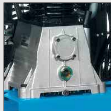
Olejoznak pre jednoduchý odpočet stavu oleja
